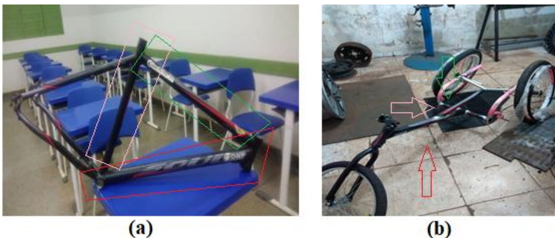
Figura 6 – Partes removidas do quadro da bicicleta e soldada na cadeira: a) quadro da bicicleta com as marcações das partes removidas; b) cadeira com as partes já soldadas.
