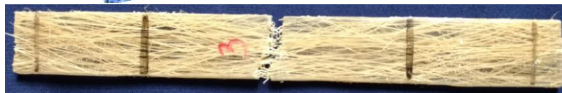
Figura 3 - Corpo de prova do compósito após a ruptura.
